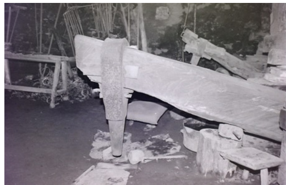
Roue hydraulique et marteau d'un martinet de Durfort
